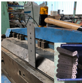
Plans, plieuse avec les pièces avant manipulation, plieuse et pièces après pliage.
