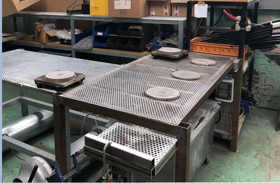
Espace de chauffe des moules (plaques).
