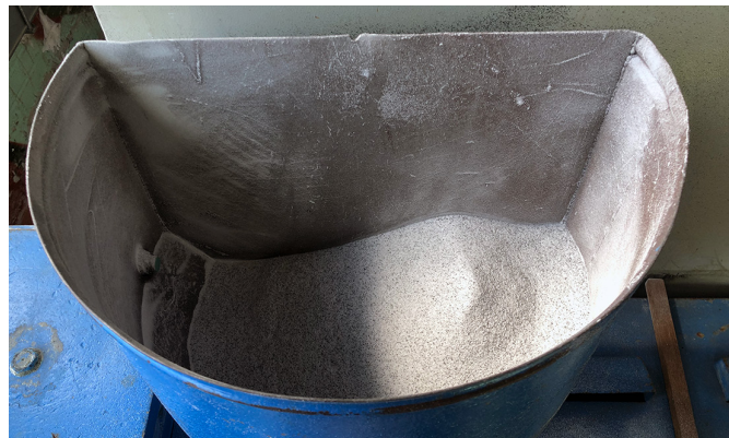
Insertion de la poudre dans la turbine.
