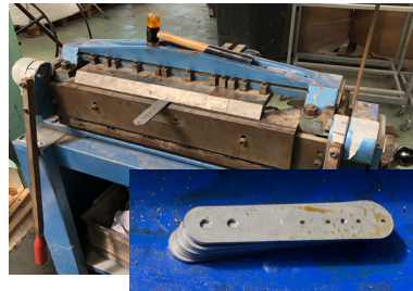
Plans, plieuse avec les pièces avant manipulation, plieuse et pièces après pliage.
